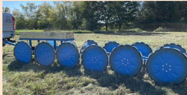
Die 6 metallischen Radpaare dienen als Elektroden
