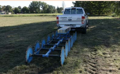
Der Geophilus kann von einem geländetauglichen PKW gezogen werden
