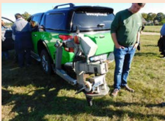
Am Agricon-Fahrzeug ist ein Arm zur Bodenprobenahme installiert
