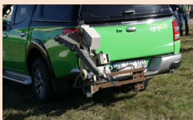
Erfassung des elektrischen Widerstands mittels EM 38
