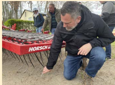
Begutachtung der Zinkendruckeinstellung
